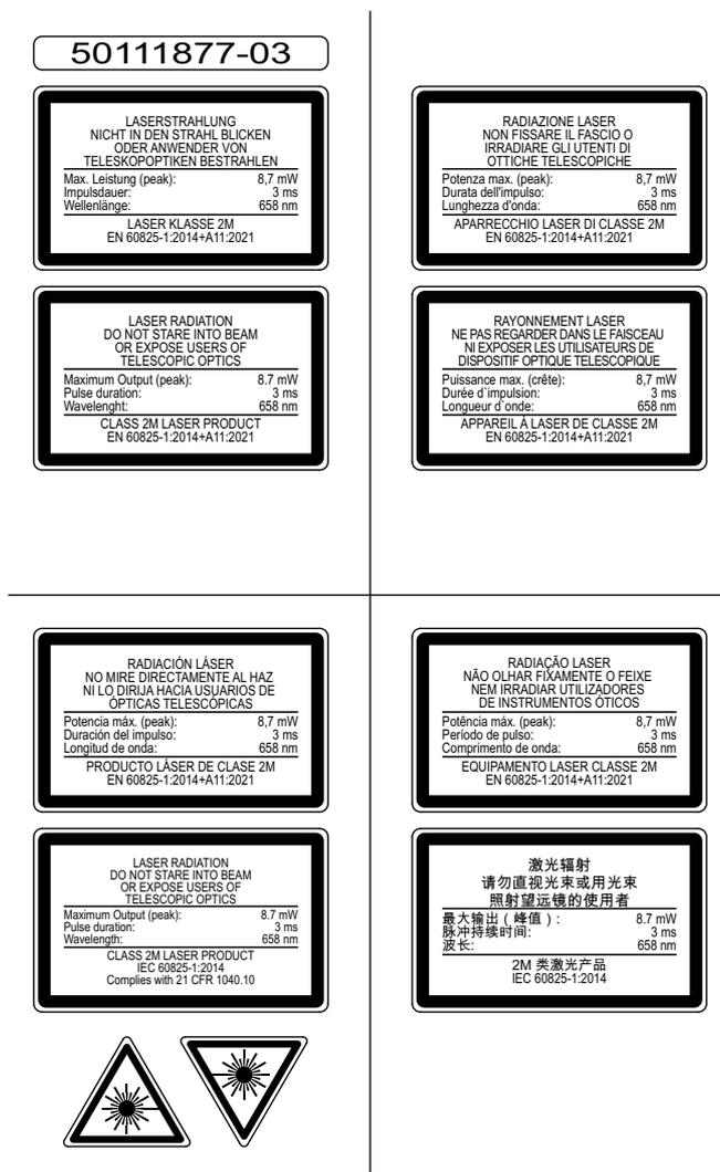
Figure 2.2 : Panneaux d'avertissement et plaques indicatrices de laser – autocollants joints
